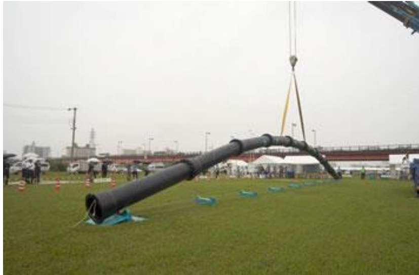
写真: φ500mm 耐震管を吊り下げている様子(日本ダクタイル鉄管協会提供)
