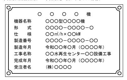
水中ポンプ端子箱等に、機器銘板と工事銘板を貼る場合、工事銘板は1枚としてもよい(施工範囲が不明確にならない場合)。
