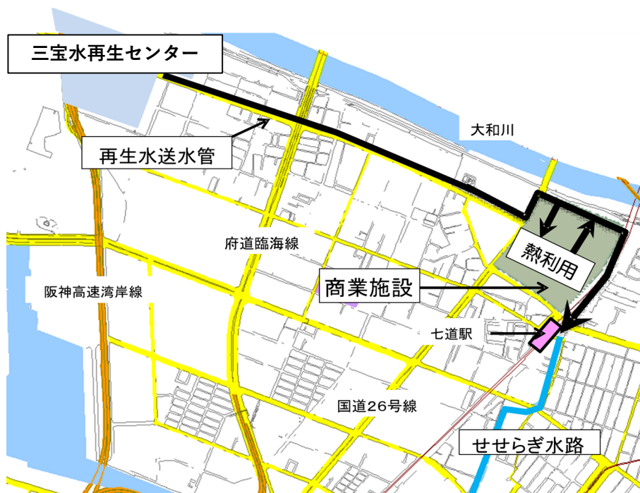
図3 鉄砲町地区への再生水供給の流れ
