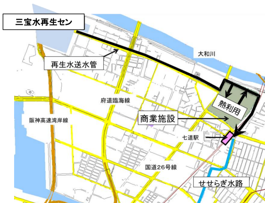
図4 鉄砲町地区への再生水供給の流れ
