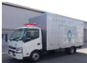
移動電源車（発電機出力625kVA）
