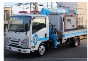
クレーン付トラック (マンホールポンプ用移動電源)
