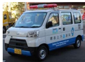
応急復旧作業車（下水道）
