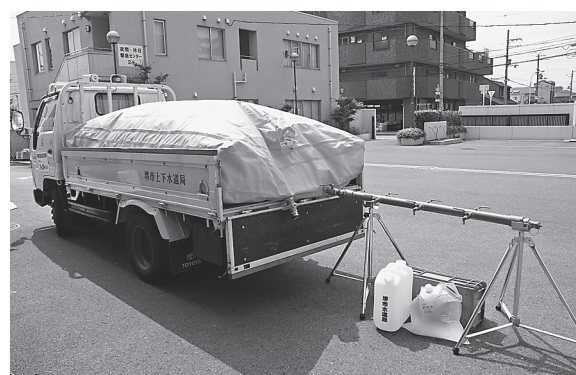
車載式ウォーターバルーン。トラックに積載することで給水タンク車となる。
