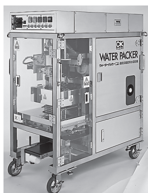
ウォーターパッカー。飲料水を袋詰めする機械。1時間に1ℓの飲料水袋を約2,000包み作ることができる。
