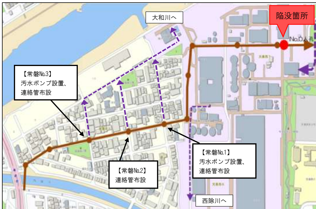
図4-2 常磐町内の仮設ポンプ設置箇所
