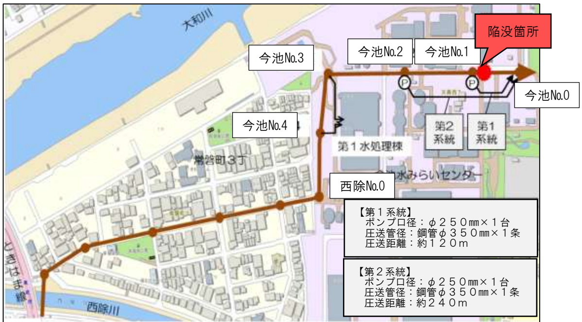
図4-1 今池水みらいセンター内の仮設ポンプ設置箇所
