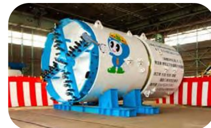
工事で使用されたシールドマシン
