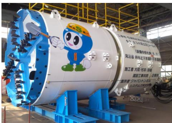
石津雨水滞水管布設工事 に用いたシールドマシン
