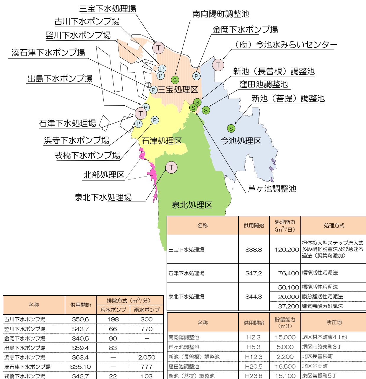
図1 下水処理場と下水ポンプ場
