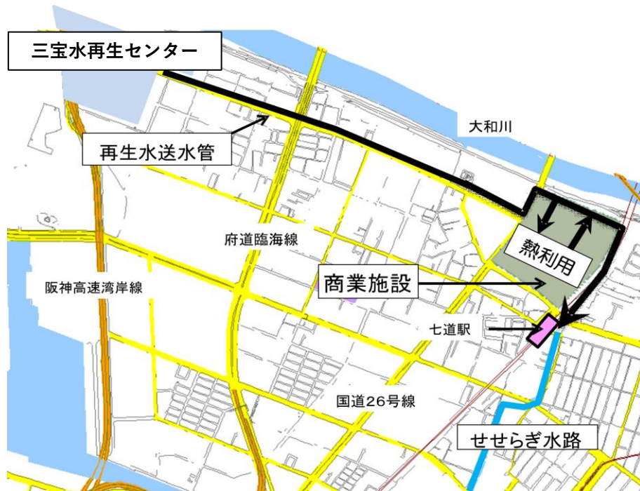
図3 鉄砲町地区への再生水供給の流れ
