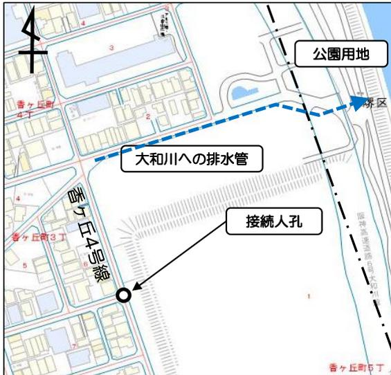
※開発地(当跡地)から西側道路(香ヶ丘4号線)内にある公共下水人孔に接続可能な場所として、左位置図に下流管渠700mmの人孔があります。接続先既設管の能力以内で、新規管布設を行い接続すること。
