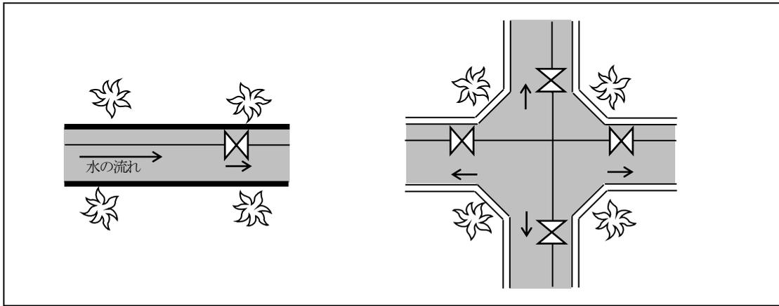
図2-2 弁栓ボックスの鉄蓋の開方向
