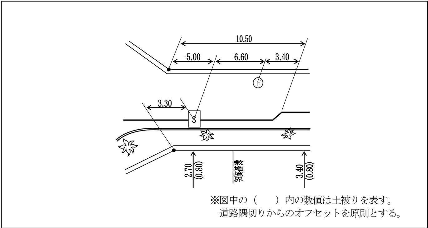
図5-4 オフセット図 作図例
